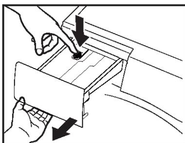
1. Удерживая нажатым рычаг для отсоединения на внутренней стороне отделения, снимите его.
