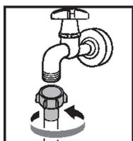
1. Подсоедините шланг для воды к водопроводному крану, а затем поверните соединительную гайку шланга по часовой стрелке, как показано на рисунке.
