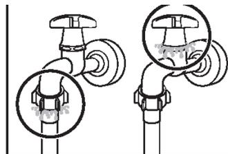
3. Откройте водопроводный кран и проверьте, не наблюдается ли утечка в местах соединения. Если утечка воды обнаружена, повторите описанные действия в предыдущих пунктах 1 и 2.
