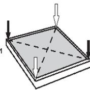
3. Чтобы убедиться, что машина установлена надлежащим образом, ослабьте стопорную гайку, как показано на рисунке, с помощью прилагаемого гаечного ключа до соответствующей высоты, пока опорная ножка не приблизится к полу, и машина не перестанет шататься.
