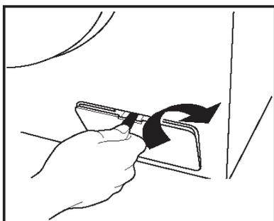
1. Откройте крышку фильтра с помощью инструментов, например, монеты, в соответствии с направлением на рисунке;
