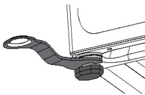
2. После установки машины, поочередно нажмите обеими руками на противоположную сторону верхней крышки стиральной машины и попробуйте покачать ее, чтобы проверить, плотно ли прилегает опорная ножка к полу и не шатается ли машина.
