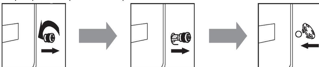
1. Выкрутите четыре транспортировочных болта с помощью гаечного ключа.
