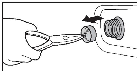
4. С помощью плоскогубцев вытащите сетчатый фильтр из впускного клапана.
