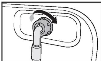
2. Подсоедините другой конец шланга для воды к впускному клапану на задней стороне стиральной машины. Поверните соединительную гайку шланга по часовой стрелке, чтобы затянуть ее.
